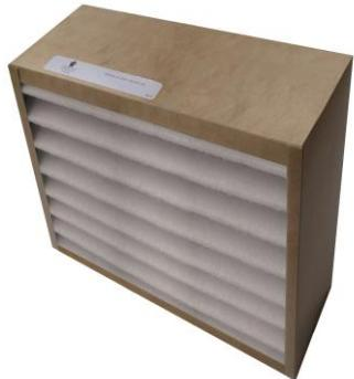
Фильтры ФВКас - III имеют размеры 225 мм x 213 мм x 100 мм и изготовлены из гофрированного высококачественного полиэстера. Их размеры **специально рассчитаны для данной приточной установки** и обусловлены аэродинамическим сопротивлением. Корпуса фильтров пропитаны водоотталкивающим веществом.
