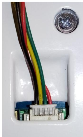
Для подключения пульта управления, приточная установка комплектуется кабелем с разъемом.
