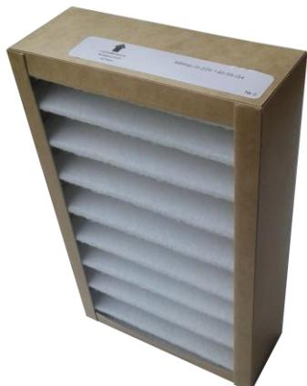
Фильтры ФВКас-III-225-140-55-G4 имеют толщину 55 мм и изготовлены из гофрированного высококачественного полиэстера. Их размеры **специально рассчитаны для данной приточной установке** и обусловлены аэродинамическим сопротивлением. Рамки фильтров пропитаны водоотталкивающим веществом и не намокают.
