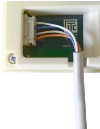
Приточная установка на базе автоматики GTC комплектуется кабелем с разъемом
