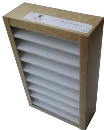
Фильтры ФВКас-III-225-140-55-G4 имеют толщину 55 мм и изготовлены из гофрированного высококачественного полиэстера. Их размеры **специально рассчитаны для данной приточной установки** и обусловлены аэродинамическим сопротивлением. Рамки фильтров пропитаны водоотталкивающим веществом и не намокают.
