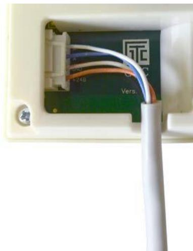
Приточная установка на базе автоматики ГТС комплектуется кабелем с разъемом
